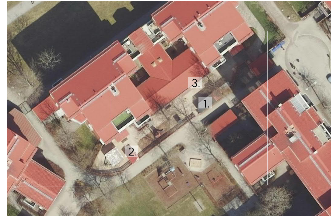
Åtgärder: 1. Sedumtak på befintlig bod. 2. Planteringskärl med klätteryväxt invid befintlig pergola. 3. Klätteryväxter sätts i planteringskärl mot vägg.
