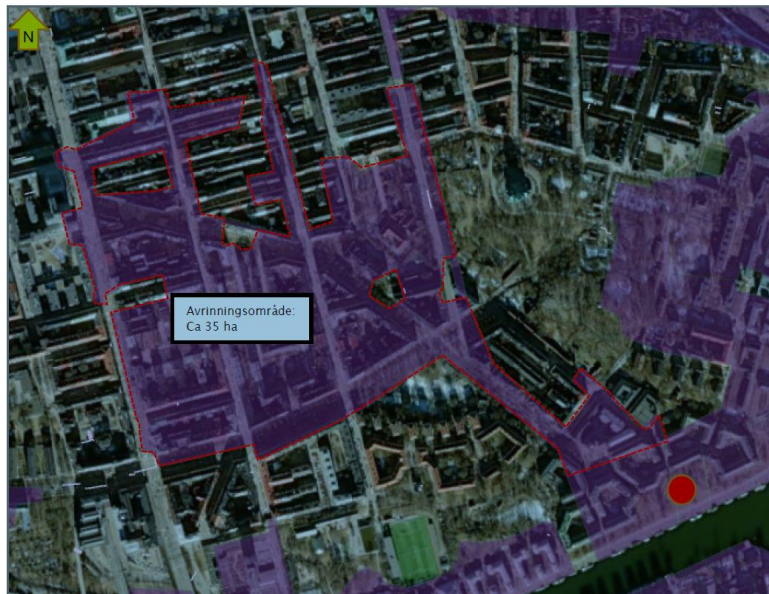
Figur 8. Ungefärligt avrinningsområde (cirka 35 hektar) för dagvattenåtgärd (röd streckad linje). Möjlig placering av reningsenhet visas med röd cirkel. För exakt placering behöver hänsyn tas till ledningar i området.
