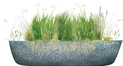
Figur 1: Biobädden är systemets reningsfunktion. En bassäng med tät botten fylls med singel upp till samma nivå som vattenytan som sedan bräddar till nästa funktion i ett system. Växter planteras efter behag och reningskapacitet. Illustration: Virbela Ateljé, Linnea Andersdotter Rundgren.
