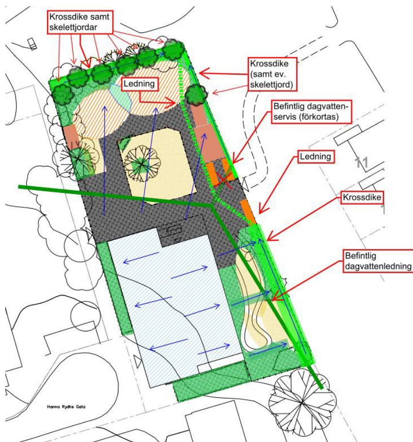
Föreslagna åtgärder för hantering av dagvatten.
