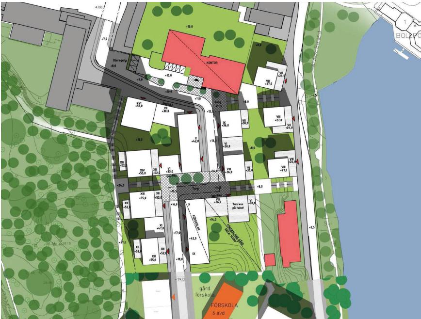
Bild (3) Plan från JM's förslag visar minskad yta för bostadsgårdar jämfört med strukturplanen från det parallella uppdraget. JM, delredovisning 1, 2016.
