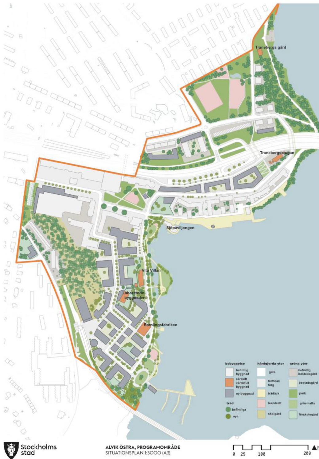
Figur 4. Situationsplan för Alvik Östra. Vitt och orange är befintliga byggnader, grått är föreslagna nya byggnader.
