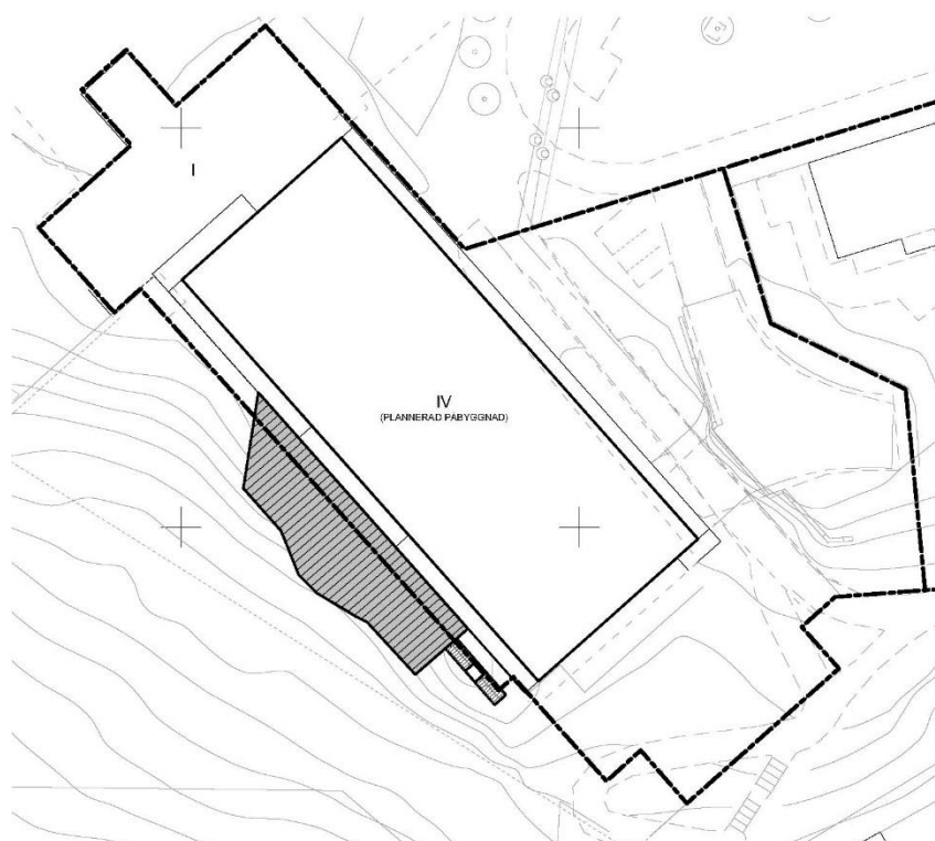
Situationsplan för den planerade uteplatsen vid befintlig byggnad på fastigheten Gåsö 2. Ytan som är skrafferad i grått visar tänkt form på uteplatsen. Bild: Liljewall arkitekter
