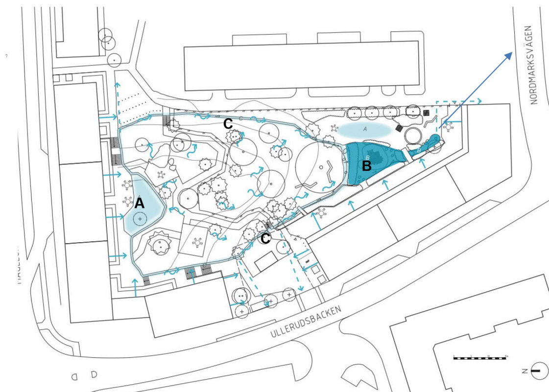
Figur 10. Principlösning LOD, västra delen framtaget av Topia Landskapsarkitekter. LOD-lösningar som presenteras är en översilningsyta (A), en regnträdgård och fördröjningsyta (B) samt avledning av dagvatten via stenkistor (C). Anslutning mot allmän ledning i Nordmarksvägen.
