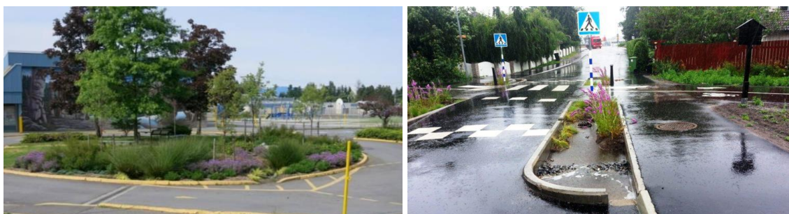
Figur 19. Till vänster: Exempel på hur en rondell kan utformas med en växtbädd för dagvattenhantering. Bild från Gibson Elementary School, 2011. Till höger: Växtbäddar som bildar ett farthinder vid ett övergångsställe i Tyresö. Bild från Goda exempel, hämtad 2018-02-27.
