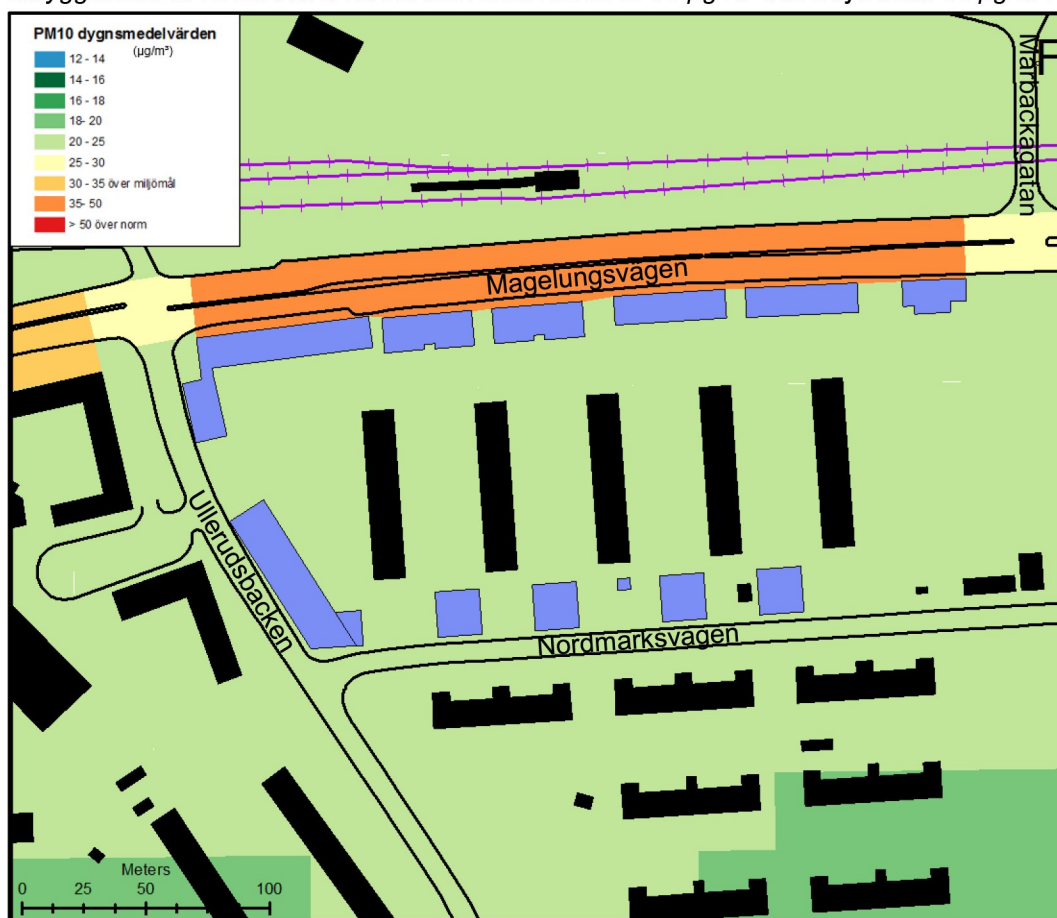
Figur 14. Dygnsmedelvärden av partiklar PM10 i \mu\text{g}/\text{m}^3 det 36:e högsta dygnet efter utbyggnaden år 2023. Normvärdet som skall klaras är 50 \mu\text{g}/\text{m}^3 och miljömålet 30 \mu\text{g}/\text{m}^3 .
