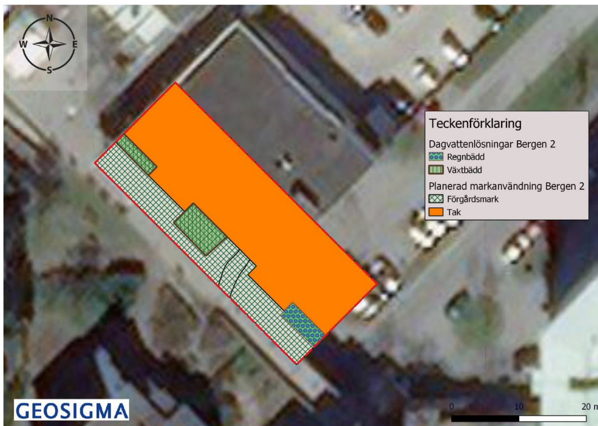
Figur 6-7. Principskiss med ungefärlig placering av föreslagna lösningar för dagvattenhantering. Utritade areor är endast exempel på placering i syfte att ge en uppfattning om lösningsförslagets ytanspråk.
