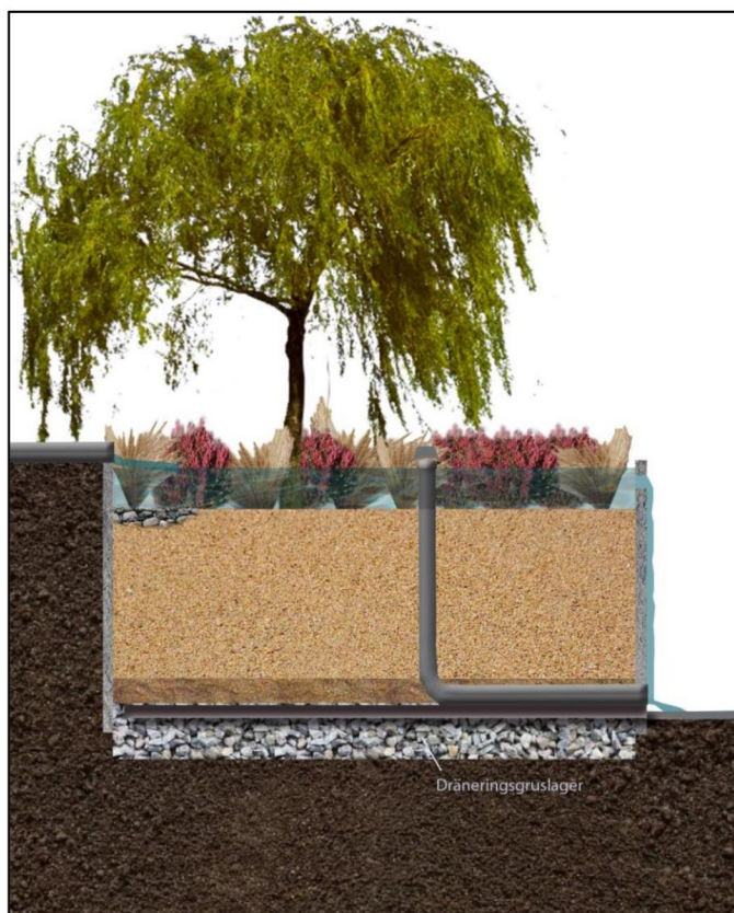
Figur 6-4. Exempelillustration av hur en regnbädd kan byggas upp (Illustration Åsa Wellander).
