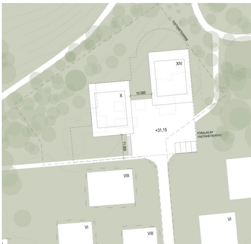
Figur 3. Ungefärligt läge på planerade flerfamiljshus samt garage i källarplan (kortstreckad linje). Fastighetsgränsen är ungefärligt markerad med långstreckad linje.
