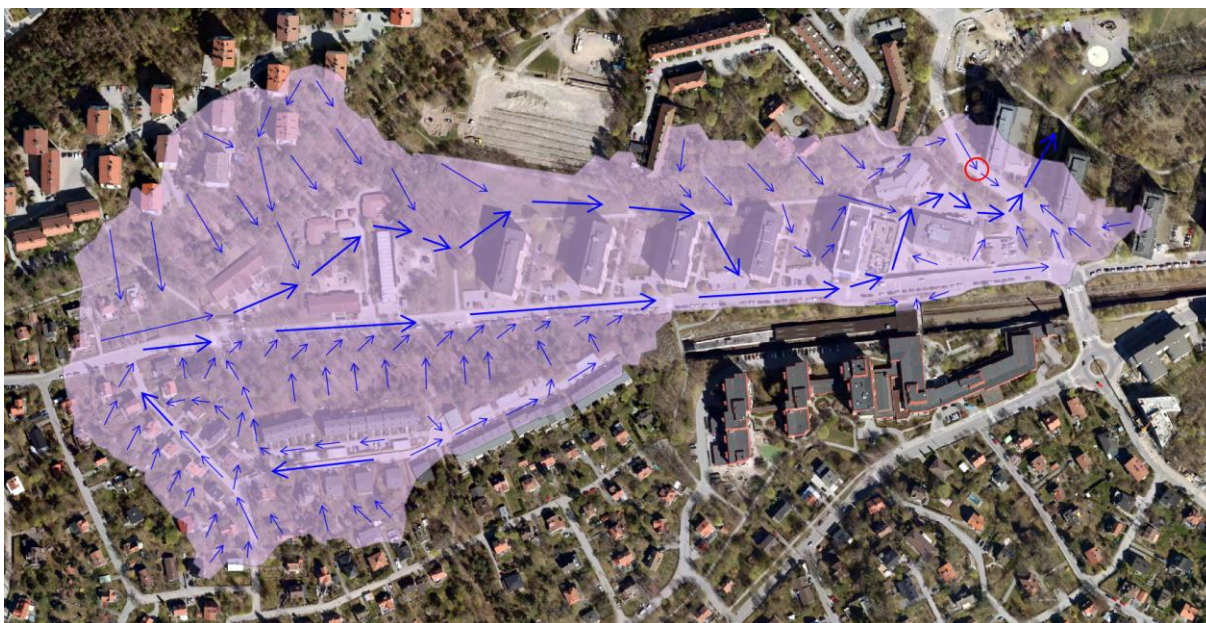
Figur 16. Avrinningsområde (lila markering) och ytliga avrinningsvägar (blå pilar) för dagvatten vid större skyfall. En lågpunkt i området bakom Axelsbergs centrum är markerad med röd ring. Notera att dagvattnet rinner vidare ut ut området i nordöst. Bilden är baserad på information från skyfallsmodelleringsverktyget Scalgo.
