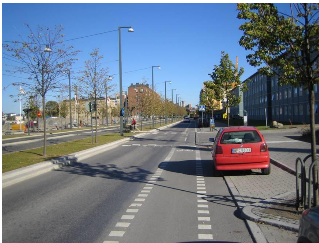
Figur 24. Träden till höger, som växer i skelettjord och får dagvatten, har gröna blad jämfört med de träd som växer till vänster där det inte är skelettjord.
