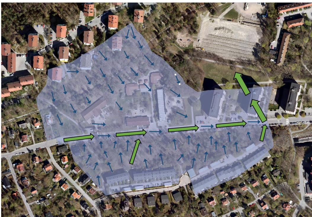
Figur 13. Tekniskt och topografiskt avrinningsområde för Fader Bergström, befintlig situation. Avrinning i ledningssystem visas med gröna pilar och den ytliga avrinningen illustreras med blåa pilar. De två tjocka gröna pilarna som leder mot nordväst illustrerar dagvattentunneln.
