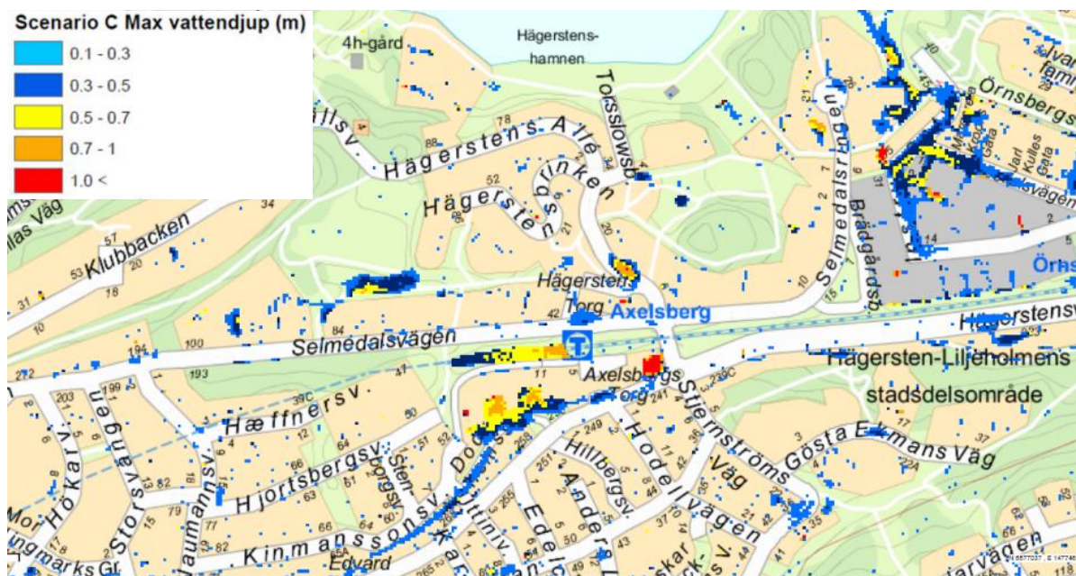
Figur 15. Skyfallsmodellering för ett 100-årsregn, vid befintlig situation för planområde Fader Bergström. Bilden visar maximalt vattendjup för marköversvämning (Stockholm Vattens skyfallsmodellering 2015).
