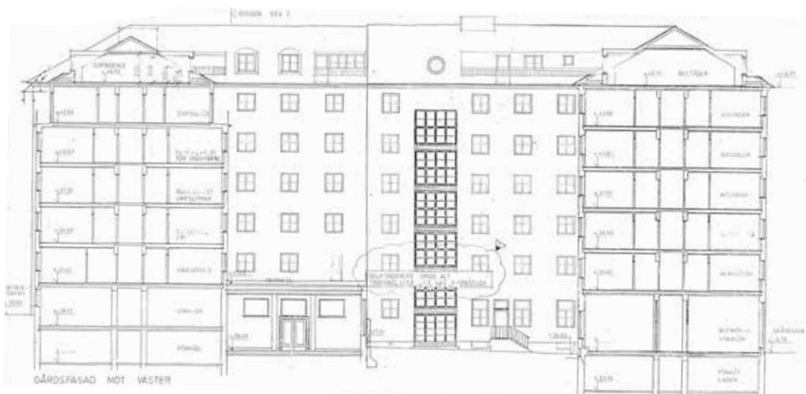
Gårdsfasad mot väster, skala 1:400 (A4). Här syns trapphusens uppglasade partier mot gården samt gårdens nivåskillnad där en del är terrasserad med en underliggande lokal. Sektionssnittet visar hur rummen genomgående är organiserade kring en mittkorridor.
