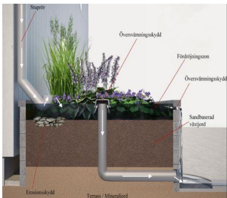
Figur 11. Principskiss över regnträdgård/växtbädd anslutning med stuprör.
