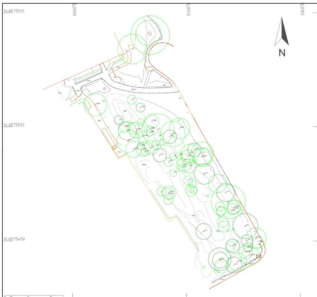
Figur 3-7. Inmätning och generell artbestämning av samtliga träd inom planområdet (InfraGeoTech mät & projektering AB).
