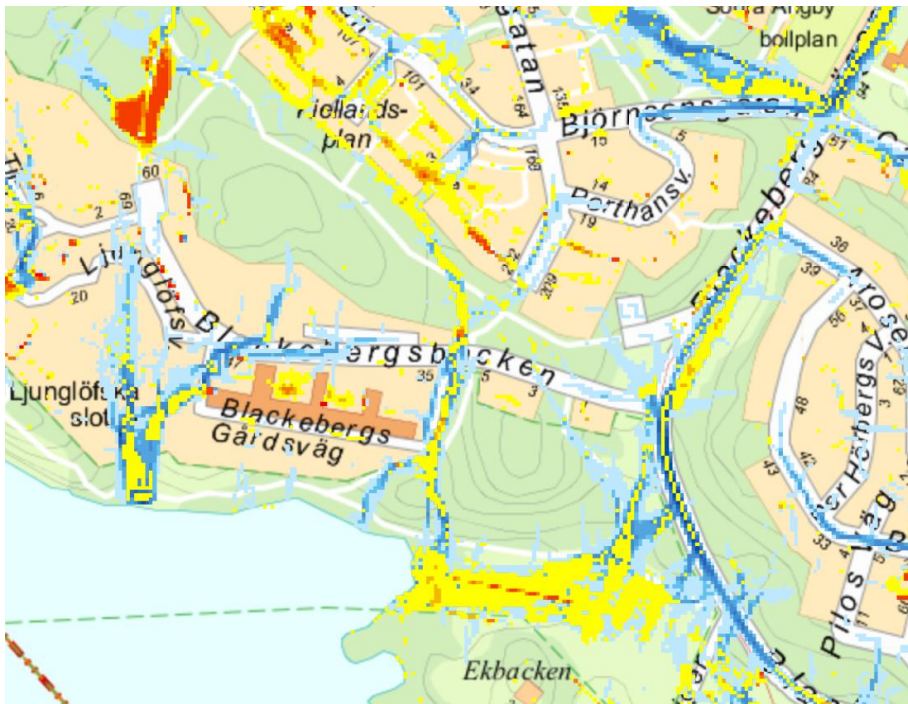
Figur 7. Stockholmsstads skyfallskartering där blått visar avrinningsvägar och gult till rött visar vattendjup (Stockholmsstads webgis)
