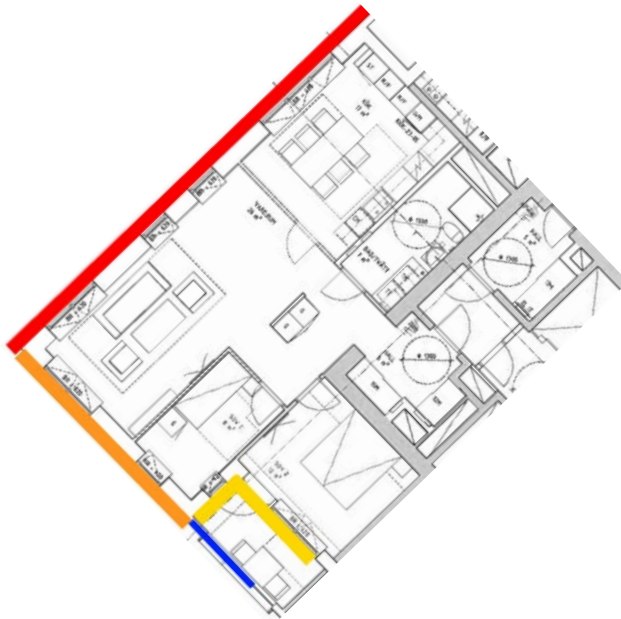
Figur 7 M15, trapphus 34. Lägenhet om tre rum och kök. Röd del av fasad överskrider 65 dB(A), orange del av fasad överskrider 60 dB(A). Genom en indragen balkong som skärmas till 75% (blått streck), ett tätt balkongräcke samt med absorbenter i tak och på fasadvägg utan fönster fås 55 dB(A) ekvivalent ljudnivå vid den gula delen av fasaden.
