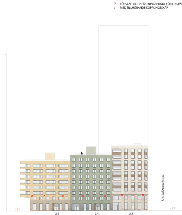
Figur 9. Exempel på hur den linspända belysningen kan ha sina infästningar och kopplingskåp på en husfasad. Skiss från 2018-05-31.
