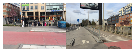
BILD 44: DUBBELRIKTAD CYKELBANA KORSA GÅNGVÄGEN TILL MARIEVIK. DÅ DET ÄR EN PENDLARLED KOMMER CYKLAR IBLAND I MYCKET HÖG FART NER FRÅN BRON. FOTO JORUNN RÅDBERG, SWECO
