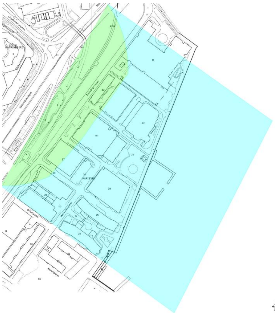
Figur 1 Markförhållanden, grön färg = fyllning på fast jord alternativt berg. Cyan färg = fyllning på lera.
