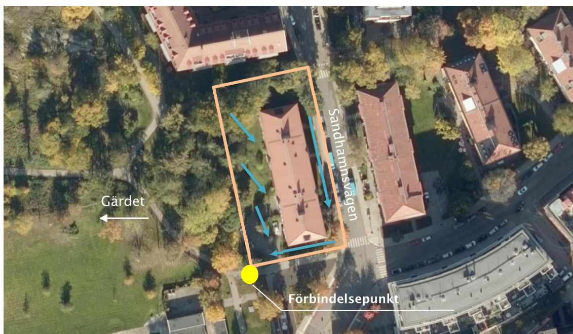
Figur 4 Utredningsområdet, generella ytliga rinnvägar (blåa pilar), och förbindelsepunkt till kommunalt avlopp. Flygfoto är hämtat från www.hitta.se ©Lantmäteriet.
