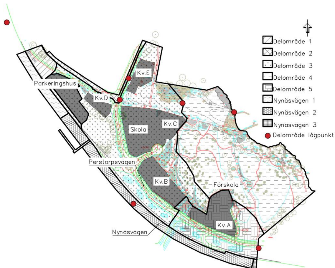
Figur 5. Delområden för beräkning av avrinning och flödesutjämning. Vid fulla ledningssystem rinner dagvatten ytledes mot identifierade lägpunkter. Dagvatten från områden utan ledningssystem rinner också till dessa lägpunkter.
