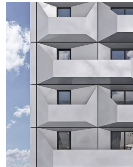
Illustration. Fasad på mälteriets rektangulära del med buller-reducerande balkonger.
