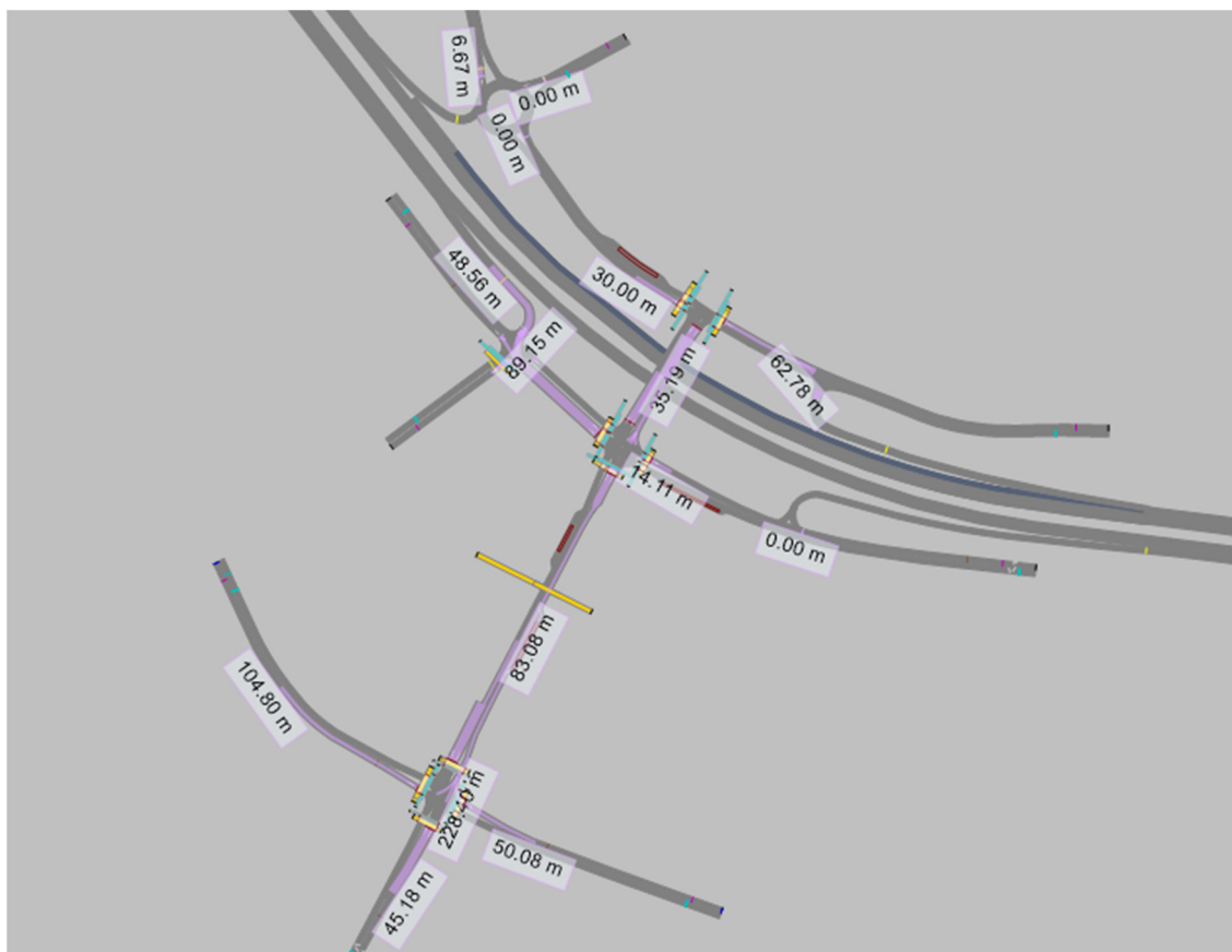
Figur 31: Genomsnittliga köllängder vid 90-percentilen över 10 simuleringskörningar för eftermiddagens maxtimme och UA1.
