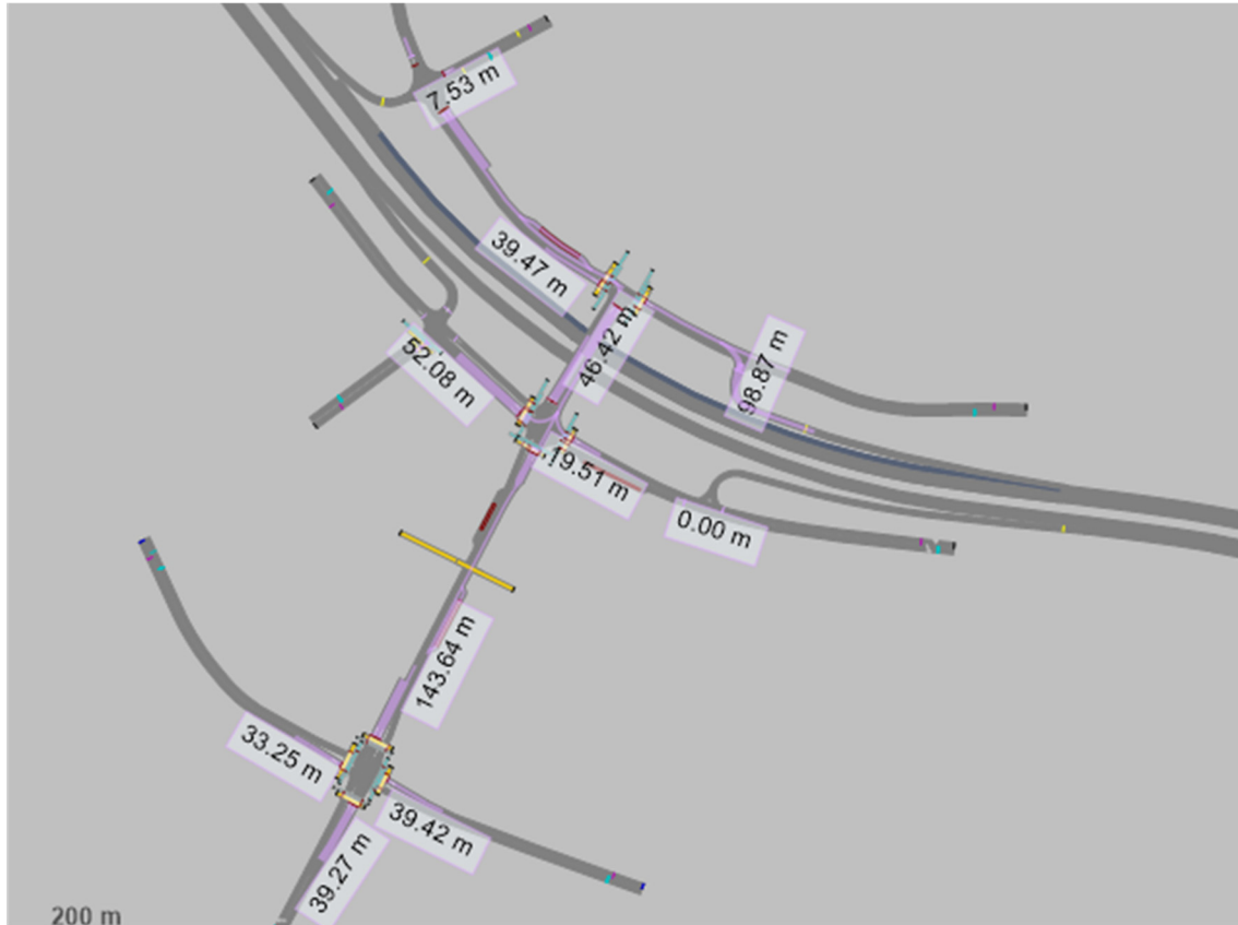
Figur 32: Genomsnittliga kölängder vid 90-percentilen över 10 simuleringskörningar för morgonens maxtimme och UA2.
