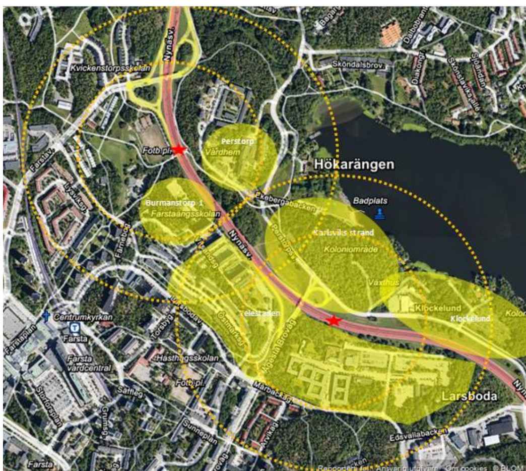
Figur 2.1. Studerad sträcka av Nynäsvägen inklusive omgivning. Den orangea cirkeln markerar ungefärligt område inom vilket konsekvenser vid en olycka på Nynäsvägen kommer att studeras. Cirkelarna har radien 250 respektive 500 meter. Stjärna visar valda platser för olycka.
