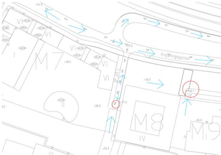
Figur 31. Översikt över lågpunkt intill garagednfart vid kvarter M7 och M8.
