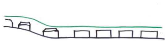
Gårdets topografi då. Byggnader placerade på/utmed höjdkurvor. Topografi avläsbar genom taklandskapet
