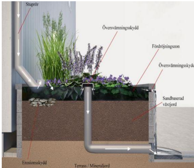
Figur 14. Principskiss över en växtbädd med stuprörsanslutning och bräddutlopp.
