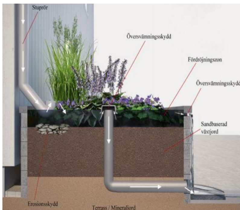
Figur 9. Principskiss över regnträdgård/växtbädd anslutning med stuprör.
