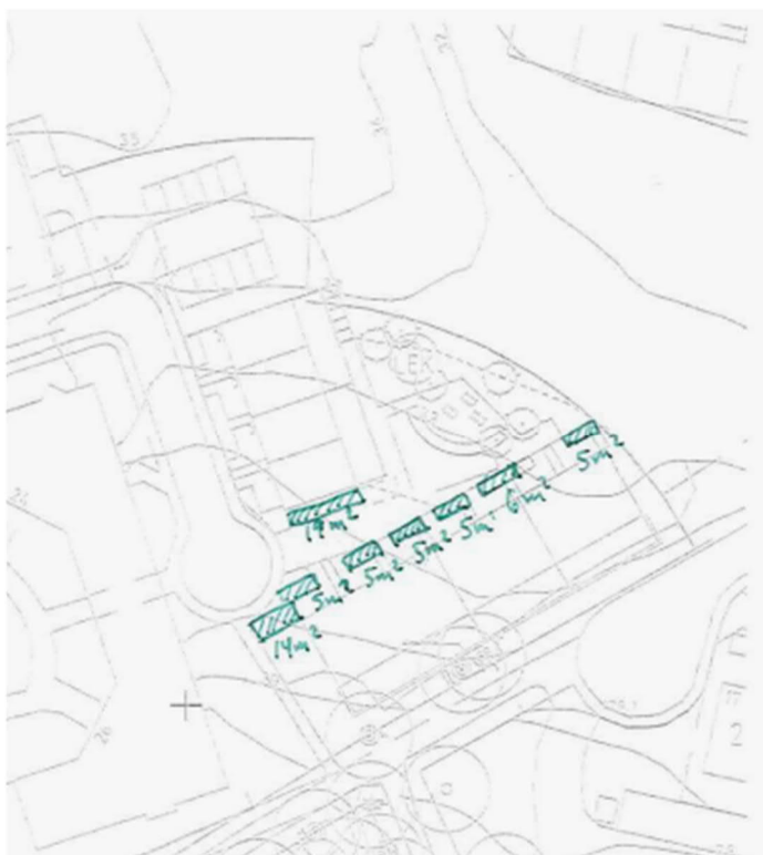
Figur 31. Principskiss över dagvattenhantering för delområde 5. Grönrandigt avser växtbäddar.
