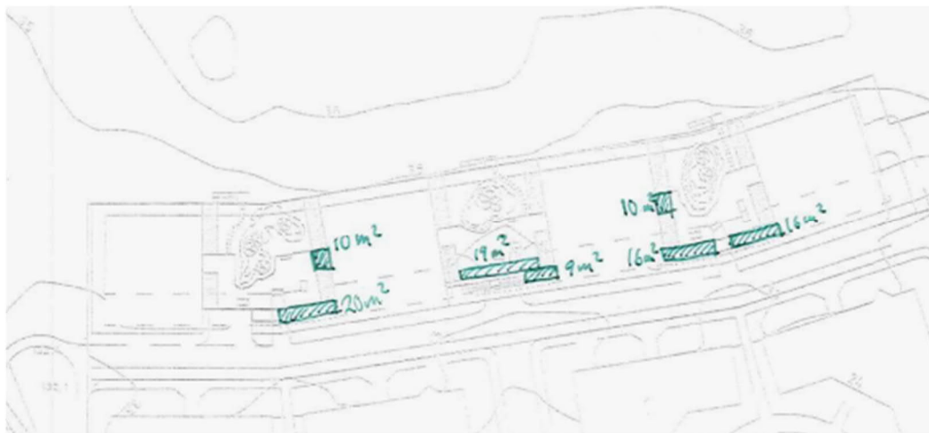
Figur 30. Principskiss över dagvattenhantering för delområde 4. Grönrandigt avser växtbäddar.
