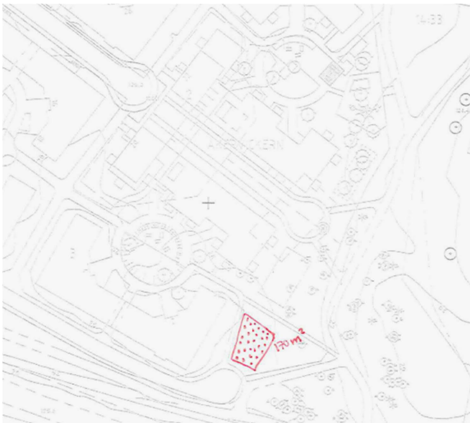
Figur 27. Principskiss över dagvattenhantering för delområde 3. Rödprickigt avser översvämningsyta.
