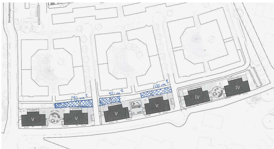
Figur 33. Principskiss över dagvattenhantering för delområde 7. Blårutigt avser makadamdiken.
