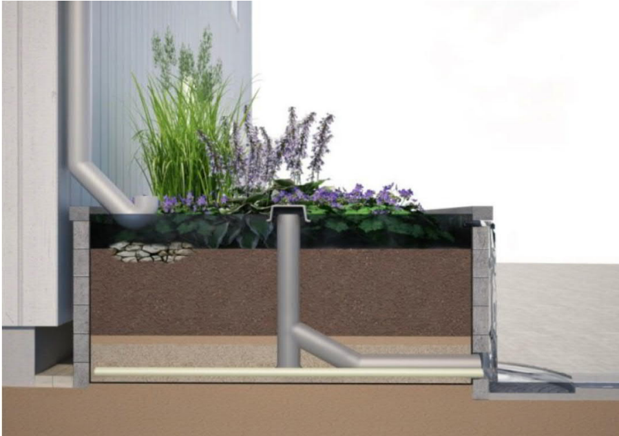
Figur 18. Principskiss på upphöjda växtbäddar (Bildkälla: Kent Fridell och Kristian Klasson, Tengbomgruppen AB.)
