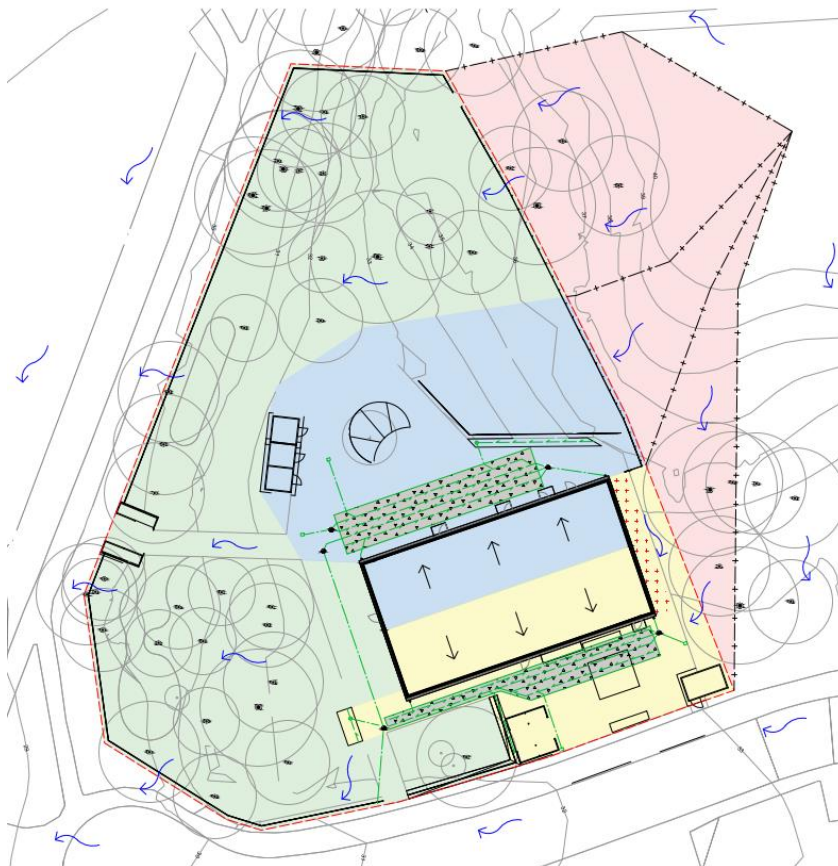
Illustration över föreslagen dagvattenplan för planområdet. Bild: Marktema.
