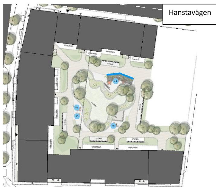
FIGUR 27. ILLUSTRATION ÖVER UTEPLATS FÖR KVARTER C. BLÅ LINJE SYMBOLISERAR EN 2,5 M HÖG PERGOLA MED SKÄRMVERKAN MOT HANSTAVÄGEN.
