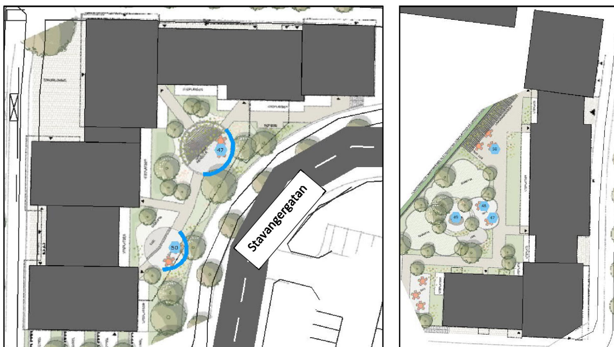
FIGUR 28. ILLUSTRATION ÖVER UTEPLATSER FÖR KVARTER F T.V. OCH KVARTER H T.H. BLÅA LINJER ÄR 2,5 M HÖGA BULLERSKYDD. KAN UTFORMAS SOM GENOMSKINLIGA SKÄRMAR ELLER PÅ ETT MER NATURTROGET SÄTT. KVARTER H KLARAR RIKTVÄRDEN FÖR UTEPLATS UTAN LOKALA BULLERSKYDD.
