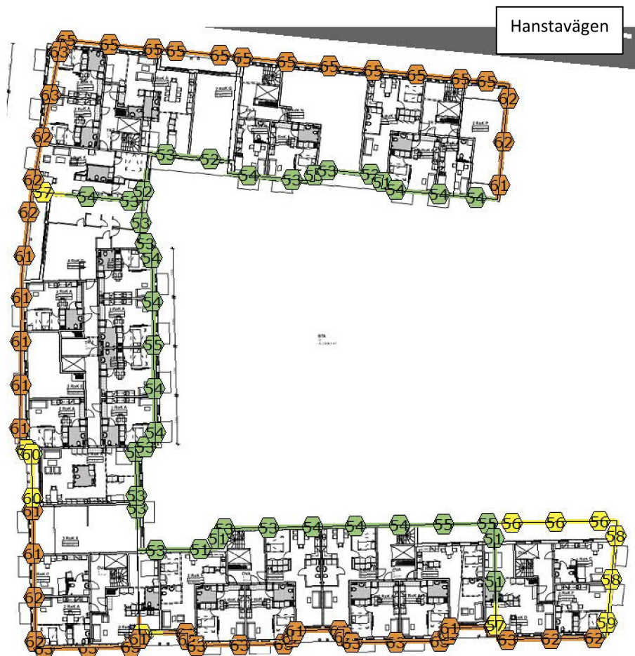
FIGUR 21. TYPPANLÖSNING FÖR KVARTER C MED EKVIVALENT LJUDNIVÅ VID FASAD. REDOVISADE LJUDNIVÅER REPRESENTERAR HÖGSTA LJUDNIVÅ VID NÅGOT VÅNINGSPÅN.
