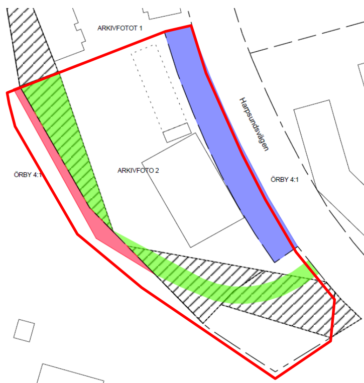
Figur 21 - Figuren illustrerar de fastighetsregleringar och servitut som blir aktuella. Röd linje visar detaljplaneområdet.
