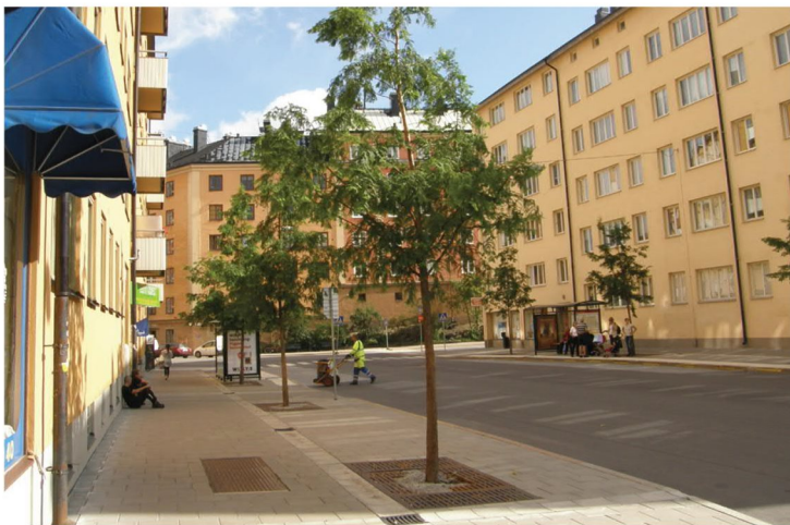
Figur 5. Träd i skelettjord med en överbyggnad som begränsar infiltration. Dagvatten leds till skelettjord främst via brunnar med sandfång. 6
