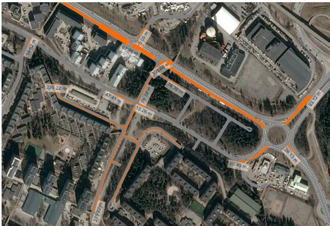
Figur 22 Kölängder (genomsnitt), i meter. Eftermiddag, Finlandsgatan har företräde. Observera att kön inte sträcker sig in på lokalgatorna som angränsar till Finlandsgatan och Noregsgatan, det är endast en effekt av hur programvaran visualiserar köer.
