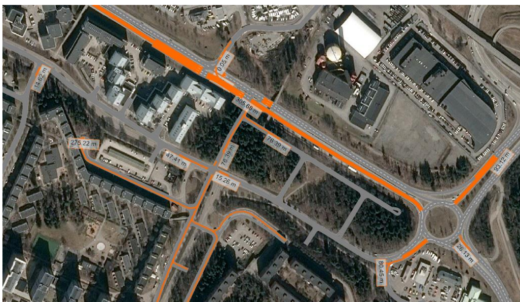
Figur 18 Kölängder (genomsnitt), i meter. Förmiddag, Finlandsgatan har företräde. Observera att kön inte sträcker sig in på lokalgatorna som angränsar till Finlandsgatan och Noregatan, det är endast en effekt av hur programvaran visualiserar köer.
