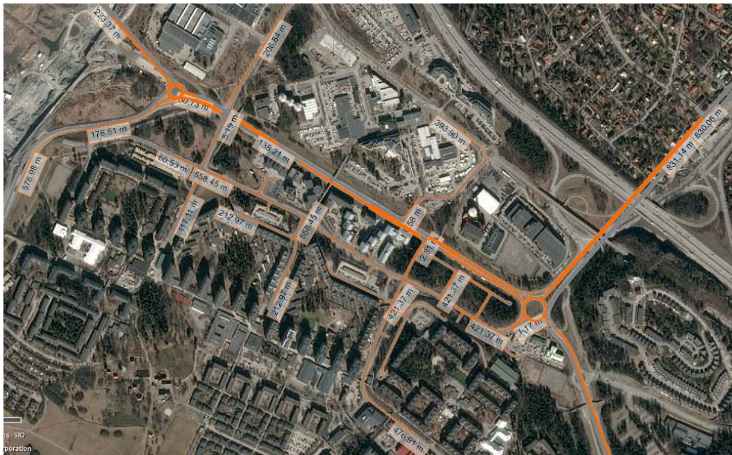
Figur 21 Kölängder (genomsnitt), i meter. Eftermiddag, Noregsgatan har företräde. Observera att kön inte sträcker sig in på lokalgatorna som angränsar till Finlandsgatan och Noregsgatan, det är endast en effekt av hur programvaran visualiserar köer. Här krävs en större vy för att fånga in köernas längder.
