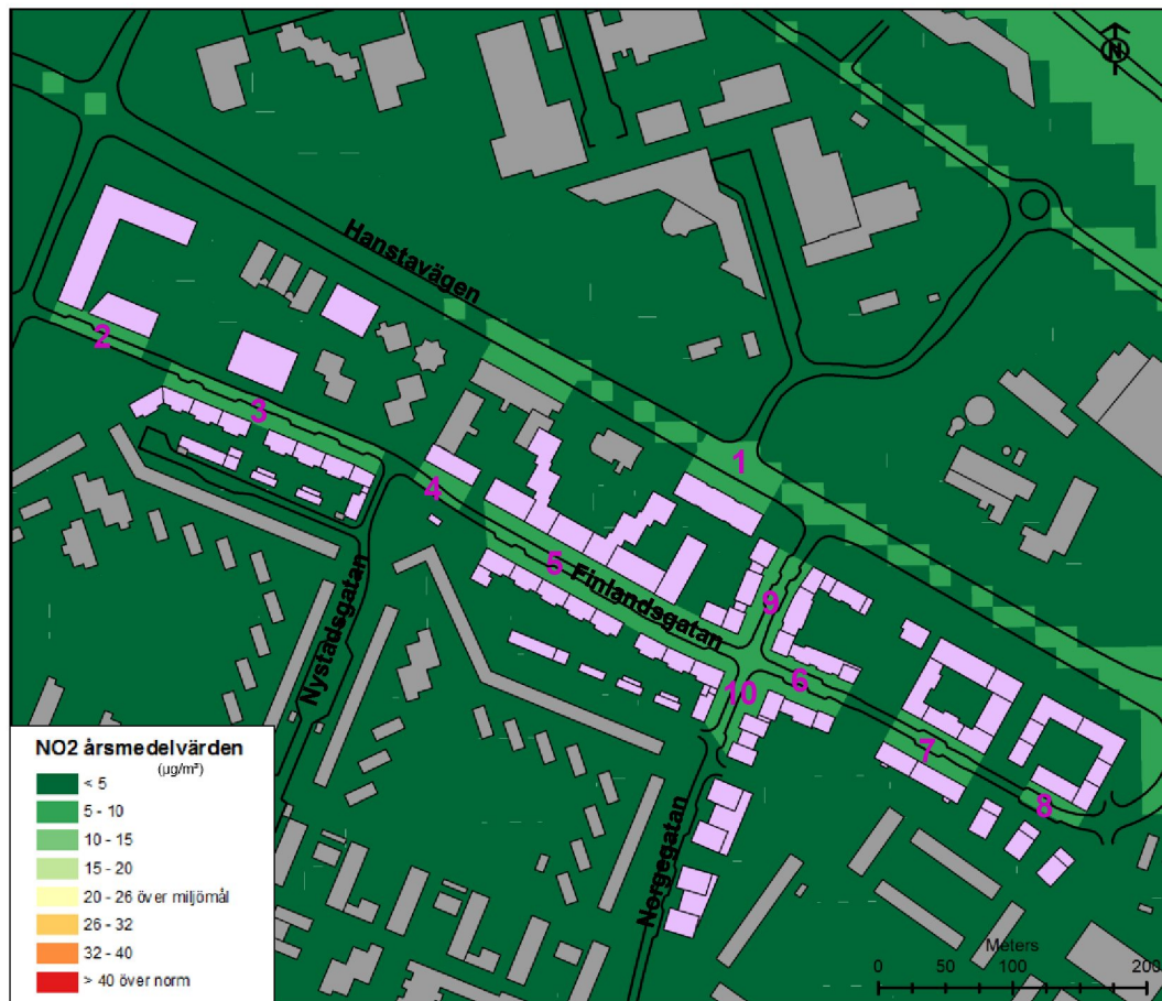
Figur 11. Årsmedelvärden NO 2 i µg/m 3 i utbyggnadsalternativet år 2040. Normvärdet som skall klaras är 40 µg/m 3 och miljömålet 20 µg/m 3 .
