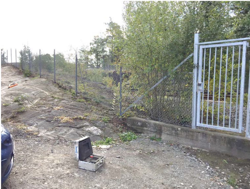
Figur 2 Bilden visar bergknallen på vilken stomljudet mättes. Accelerometern fästes på berget ungefär i läget för väskan som ses i bild.
