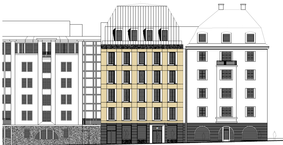
Fasad mot Regeringsgatan alternativ med samtida utförande av sockel. (AIX Arkitekter)
