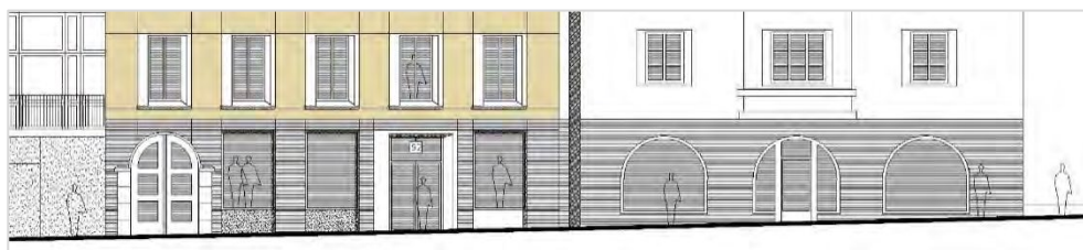
Alternativt sockelgestaltning, där naturstensomfattningar och den vävda entrén till ett före detta garage återbrukats.
