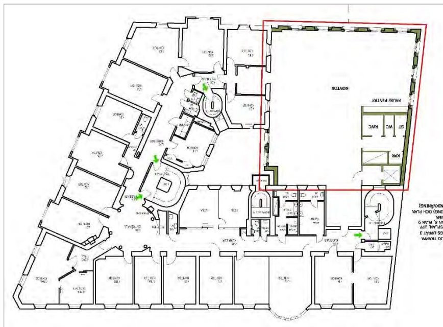
Tillbyggnadsförslaget normalplan som redovisar hur man har för avsikt att koppla samman den nya byggnaden med den befintliga. Källa: AIX förslagsritning.
