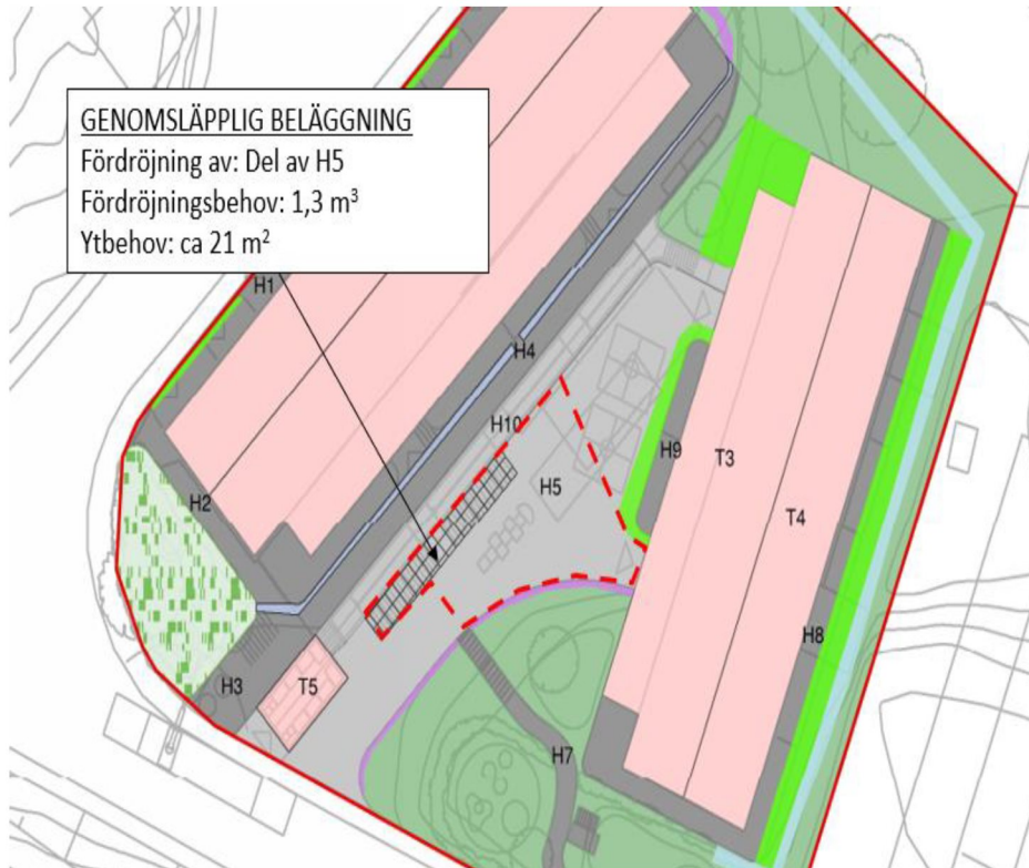
Figur 22. Illustration över vilka ytor som leds till genomsläpplig beläggning.
