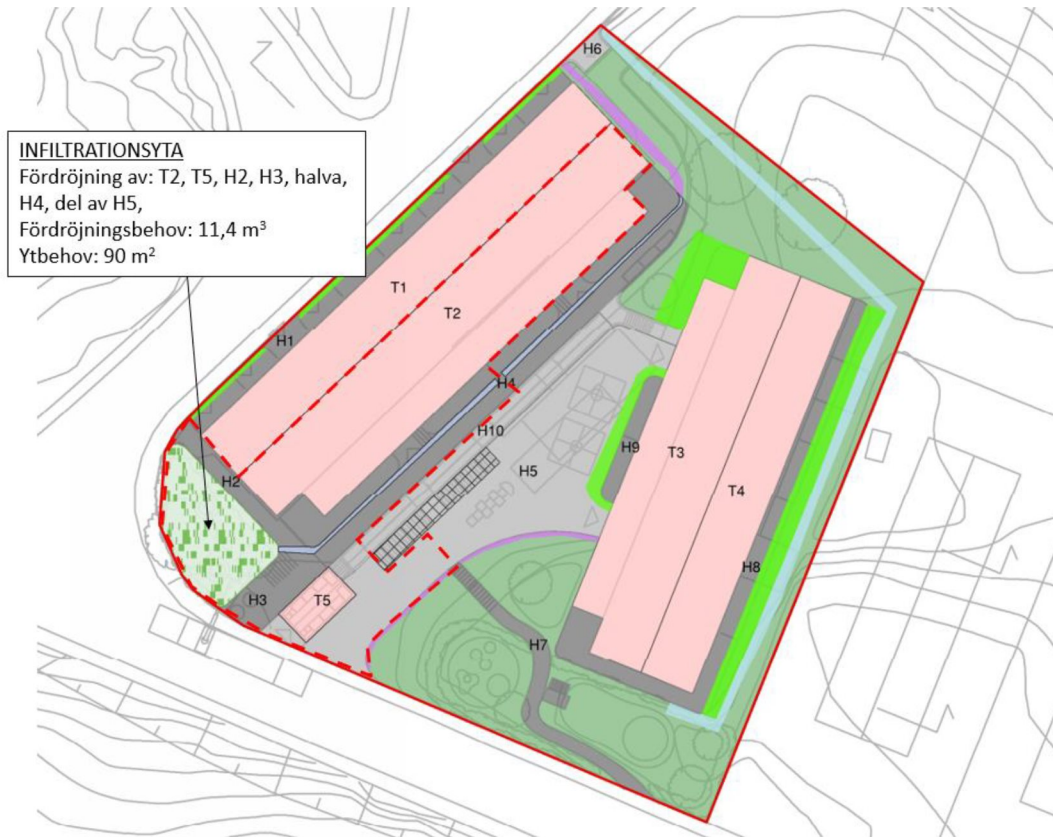
Figur 19. Illustration över vilka ytor som leds till infiltrationsyta.
