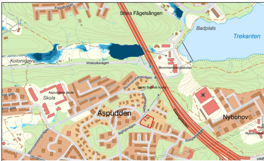
Figur 14. LstAB Översvämningskartering med översvämningsrisk vid skyfall, lågpunktskartering samt flödesackumulationslinjer (Lst AB Länskartan Stockholms län, 2020-10-15).
