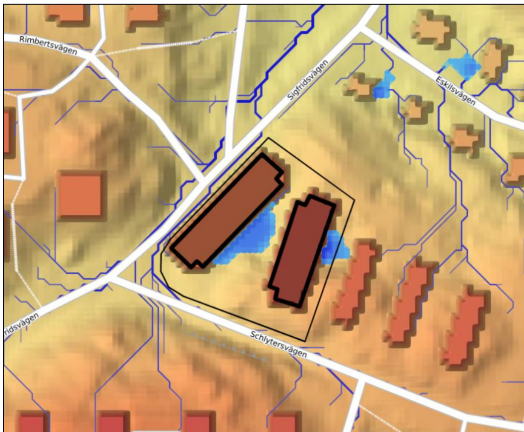
Figur 13. Avrinningsvägar och lågpunkter vid befintliga höjder på mark och justerade höjder där nya hus planeras, modellerat med SCALGO Live vid 50 mm regn.
