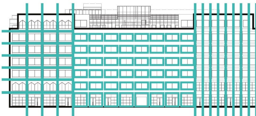
Illustration som visar fasadkonceptet; ett byggnadsmaterial (tegel) som varieras och ger byggnaden både vertikal och horisontell indelning (Fojab).
