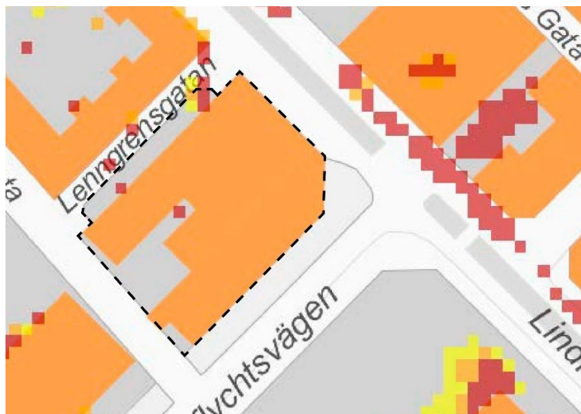
Skyfallskartering – sannolikhet för översvämning med minst 0,1 m djup vid ett 100 - årsregn (Stockholm Vatten och Avfall, samt miljöförvaltningen, 2015).
