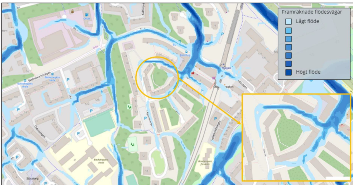
Figur 16. SVOA:s skyfallsmodell med fokus på flödesvägar. Förstorad bild över planområde syns i nedersta högra hörnet (Stockholm Vatten och Avfall, 2020).
