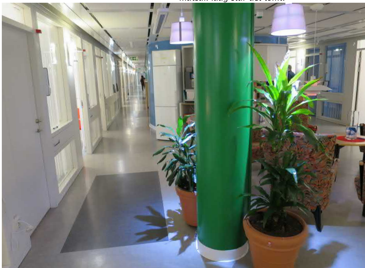
Kontorsvåningarna har i huvudsak ursprunglig planlösning med cellkontor på var sida om en öppen och pelaromgärdad zon där trapphus och hiss och andra allmänna funktioner som pentry och kapprum med wc också är placerade.
