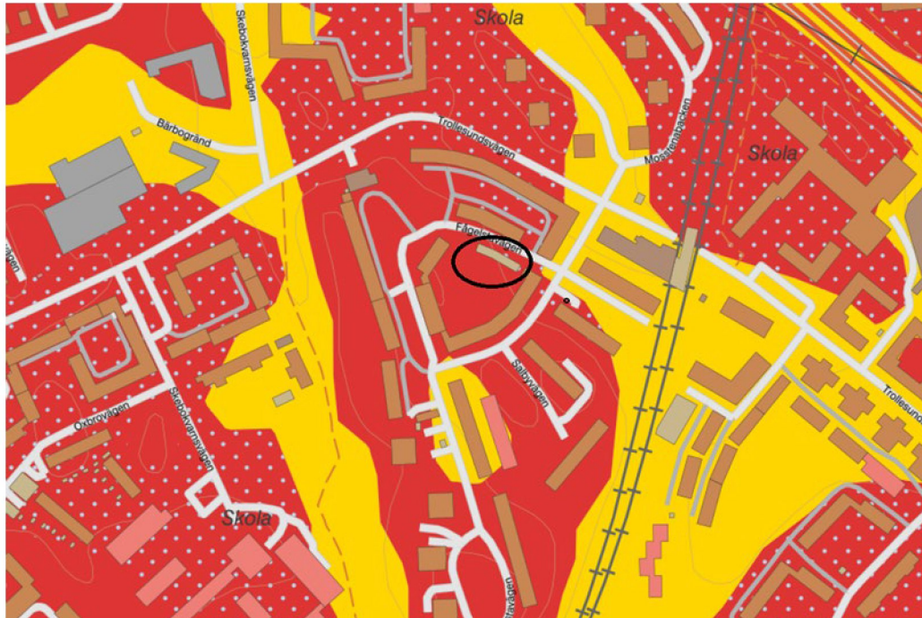
Figur 3. Karta med undersökningsområde markerat med röd cirkel (SGU Kartvisaren 2020 rött: urberg, rött med ljusblå prickar: tunt moräntäckte på berg, gult: postglacial lera)
