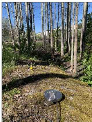
Bild 1 visar vibrationsgivare på berg i mätpunkt 1
