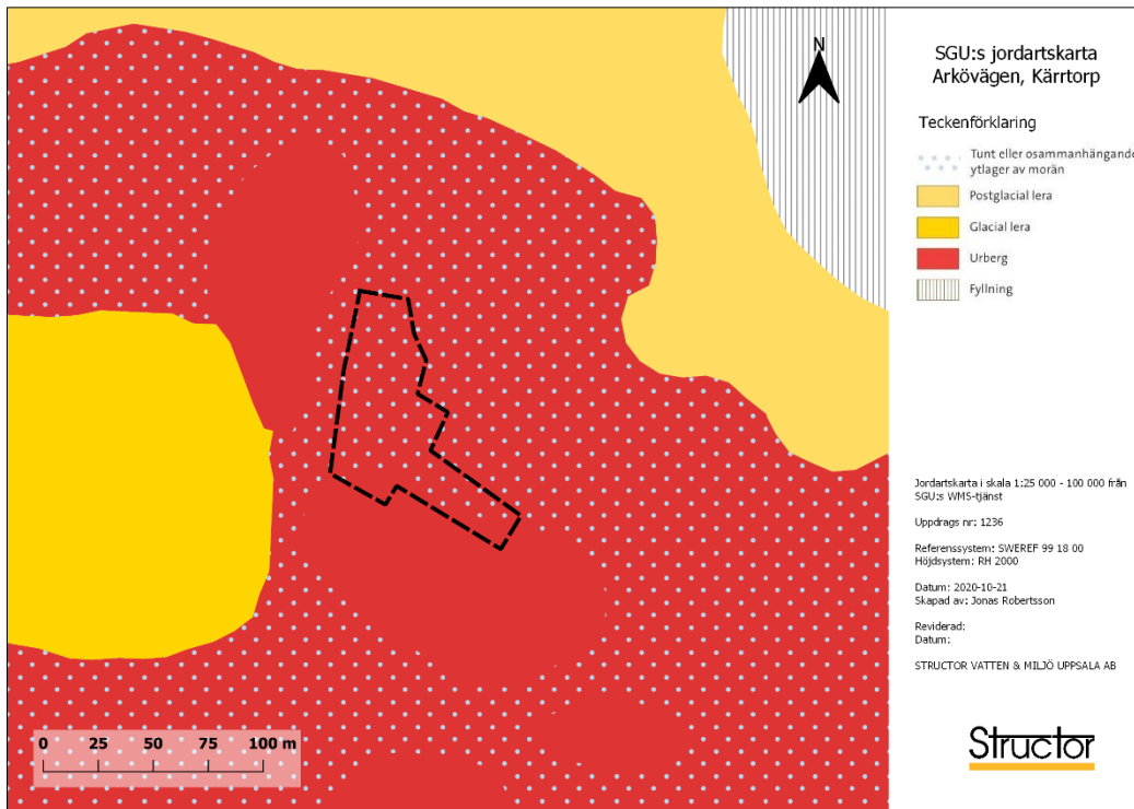
Figur 4-2. Jordarter enligt SGU:s jordartskarta. Utredningsområdesgränsen visas med en svartstreckad polygon. Jordartskartan utgår från modellresultat och ska inte tolkas exakt, och kan därmed inte ersätta eventuellt behov av en geoteknisk utredning.
