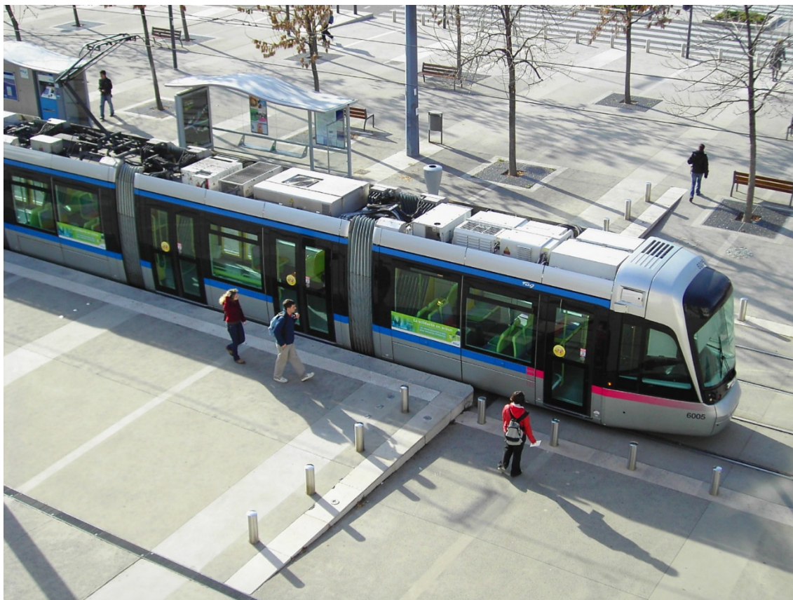
Figur 18 visar ett förslag på en passage i markplan i torgmiljö med pollare som tydliggör spårområdet.
