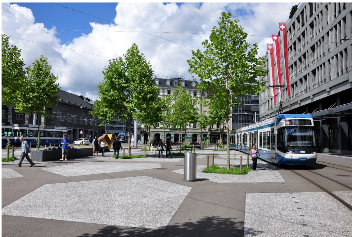
Figur 21 visar en form av markeringar utmed spår i torg-miljö för att påvisa det ungefärliga utrymmet kring rälen som spårvagnen behöver för att passera.
