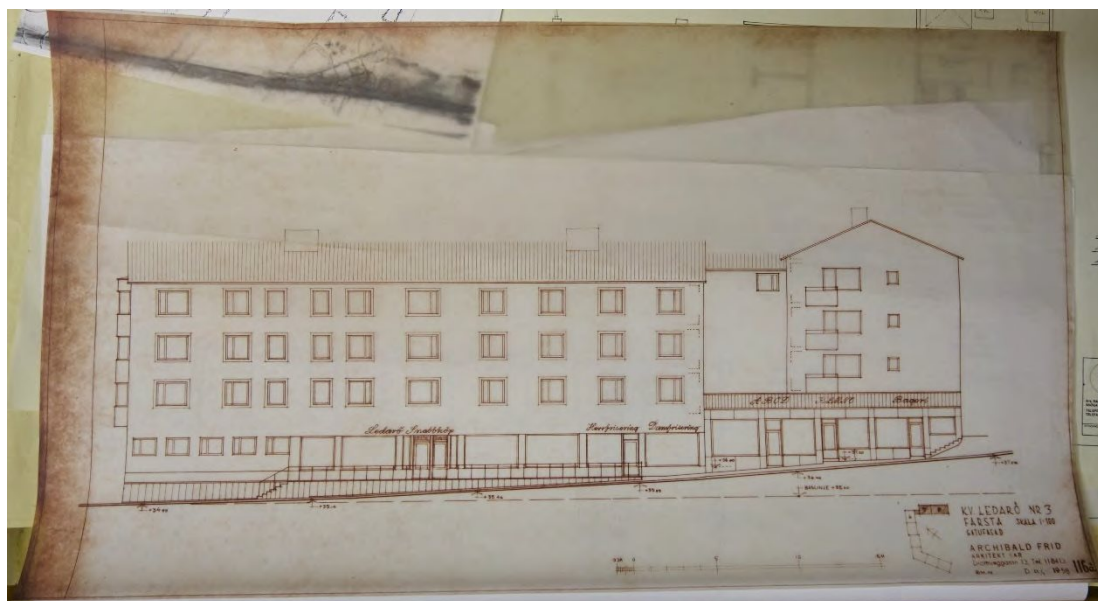
Ritning för gatufasaden mot Lysviksgatan i öster. Ritningen är daterad 1958. Sammanlänkningen mellan de båda byggnadskropparna, liksom den enväniga butiksbyggnaden i gatuhörnet (till höger i bild), är två av delar som realiserades genom den planändring som genomfördes 1956. Källa: Olov Lindgren AB:s fastighetsarkiv.
