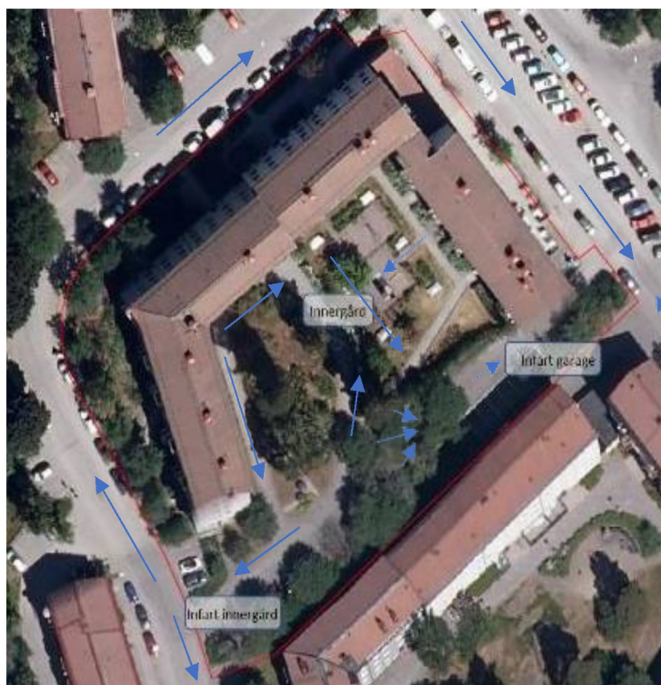
Ortofoto med planområdet markerat i rött och generella ytliga flödesriktningar som blå pilar. (Bild: Sweco)
